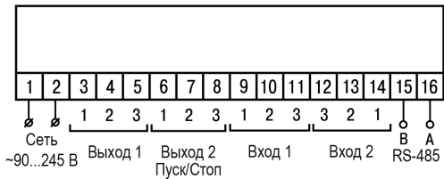
Рисунок 5.2 – Общая схема подключения ТРМ210-Н, -Щ1 и -Щ2
