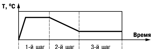
Рисунок 3.2 – Пример Программы технолога для ТРМ151-06
