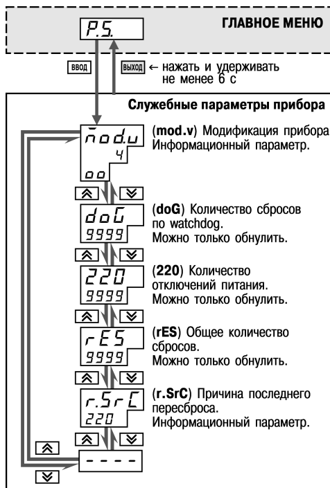
Рисунок 11.18 – Схема доступа к служебным параметрам прибора
