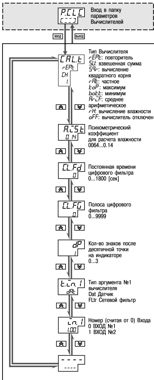
Рисунок 11.11 – Схема задания параметров Вычислителей
