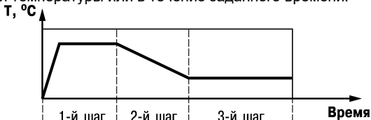
Рисунок 3.2 – Пример Программы технолога для ТРМ151-03
