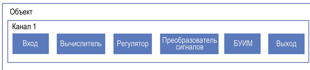
Рисунок 1.1 – Структура канала обработки сигнала со входа, формирование управляющего сигнала и передача на выход
