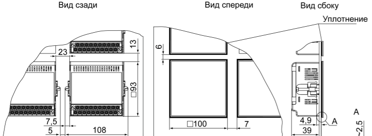
Рисунок 6 – Габаритные размеры корпуса Щ11
