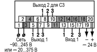
Рисунок 11 – Назначение контактов клеммной колодки прибора в корпусе Щ11
