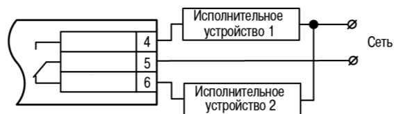
Рисунок 12 – Схема подключения нагрузки к ВУ типа Р
