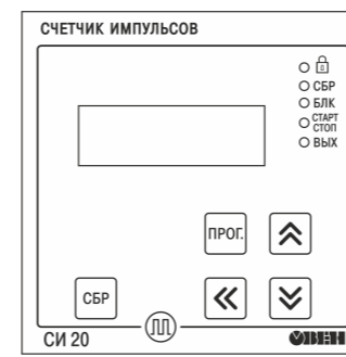
Рисунок 17 – Лицевая панель прибора для корпуса настенного (Н) и щитового (Щ1) креплений
