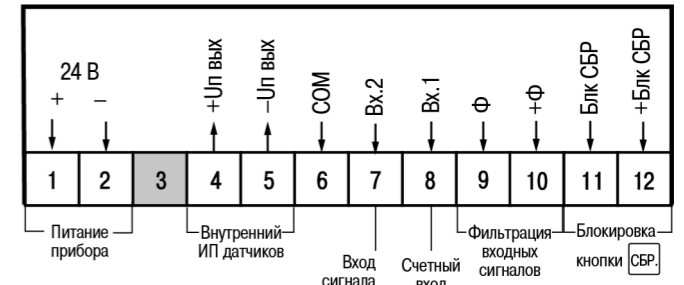
Рисунок 5.1 – Назначение контактов клеммника
