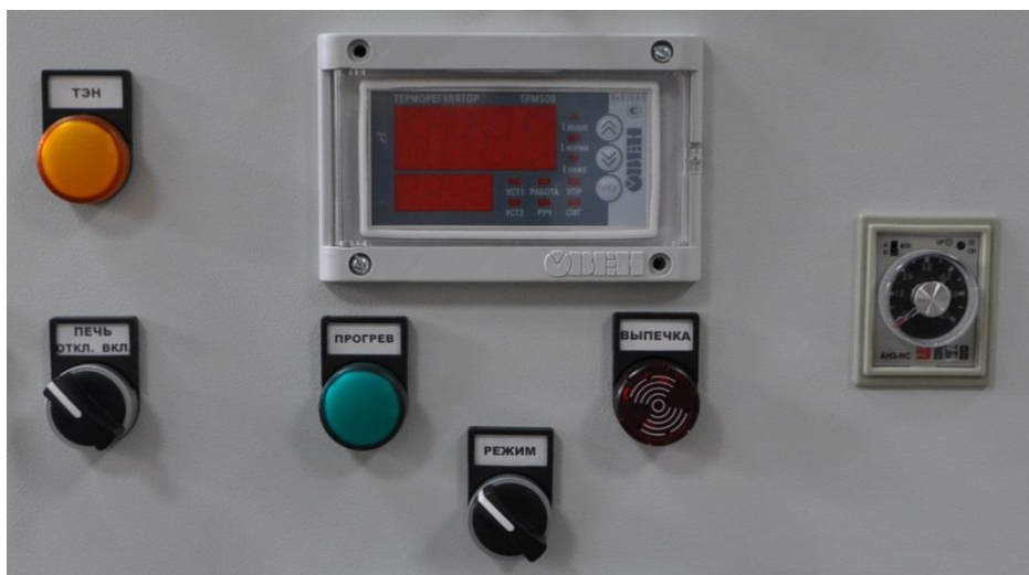
Рис.1. Панель управления одной секцией ШЖ-150
