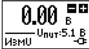
Рисунок 4.3 – Экран прибора в режиме измерения напряжения
