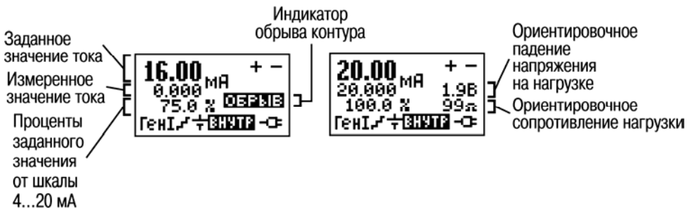
Рисунок 4.4 – Экран прибора в режиме измерения напряжения
