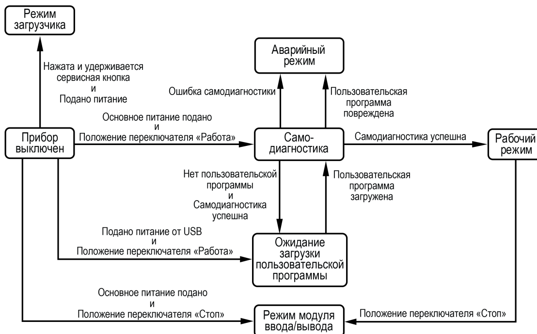
Рисунок 7.7 – Схема переходов между режимами работы
