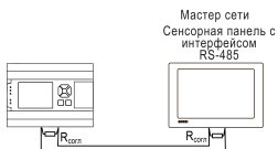
Рисунок 13 – Типовая схема подключения в режиме Slave
