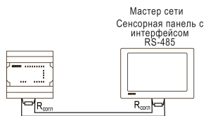
Рисунок 6 – Типовая схема подключения для PR100 в режиме Slave
