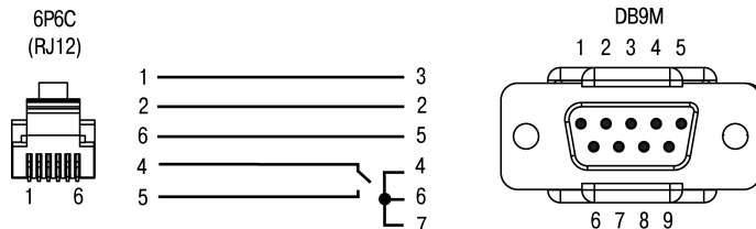
Рисунок В.2 - Схема кабеля KC3 для подключения модема к ПЛК154 по интерфейсу RS-232 Debug
