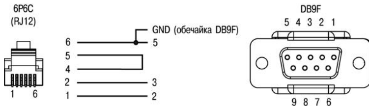
Рисунок Г.1 – Схема кабеля программирования КС1, входящего в комплект поставки
