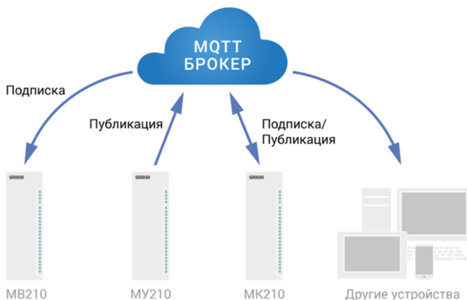
Рисунок 6.2 – Структурная схема обмена по протоколу MQTT
