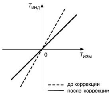
Рис. 3.6. Коррекция "наклон характеристики"
