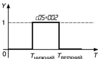
Рис. 3.16. Компаратор срабатывает внутри установленных пределов
