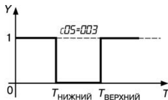
Рис. 3.17. Компаратор срабатывает вне установленных пределов
