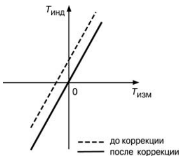
Рис. 3.5. Коррекция "сдвиг характеристики"
