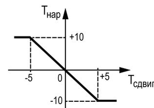
Рисунок 10.7 – График зависимости температуры сдвига от наружной температуры
