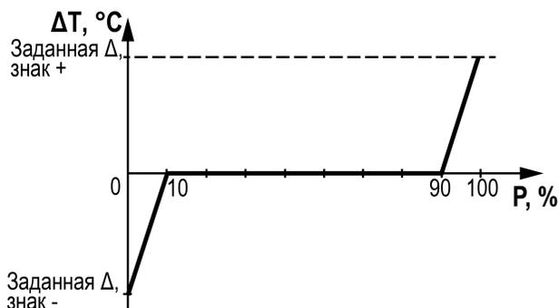
**Рисунок 10.9 – Коррекция уставки по тепловой нагрузке потребителя**
