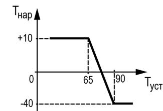
Рисунок 10.8 – График зависимости температуры уставки от наружной температуры
