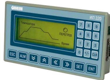
Графическая панель оператора ИП320 поддерживает совместную работу с ОВЕН ПЛК, с модулями ОВЕН МВА8, МВУ8, а также с приборами и контроллерами других производителей
