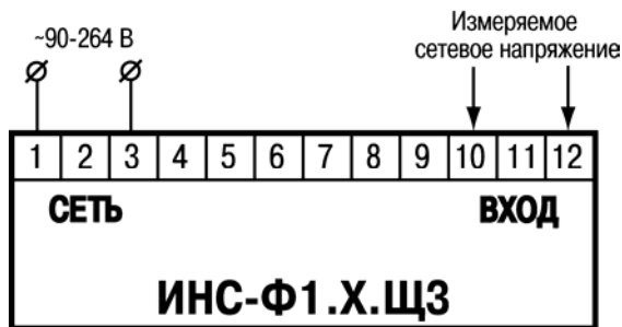
Рисунок Б.1 – Схема подключения прибора ИНС-Ф1.х.ЩЗ
