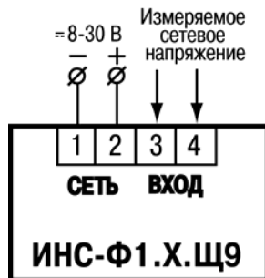
Рисунок Б.2 – Схема подключения прибора ИНС-Ф1.х.Щ9
