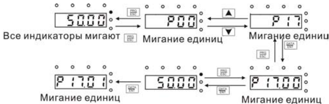
Рис. 5-4 Схема слежения за состоянием ПЧ
