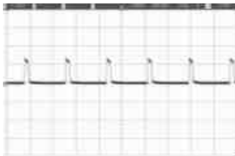
Рис. 4.10. Осциллограмма сигналов управления диодно – тиристорным модулем (200 мкс/дел; 1,0 В/дел).
