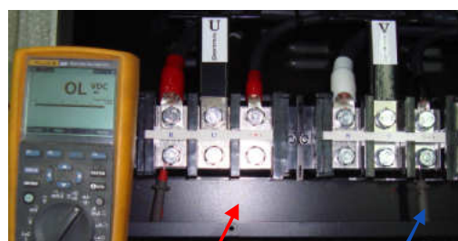
Щуп Ω прибора к клемме R
