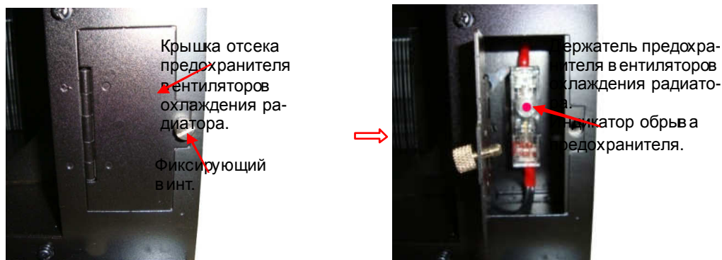
Рис. 4.26. Предохранитель цепи питания вентиляторов охлаждения радиатора
