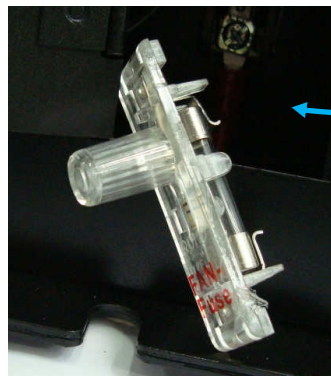
Предохранитель вентиляторов охлаждения радиатора. Подключение щупов прибора.
