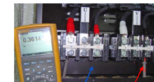
Щуп COM прибора к клемме R
