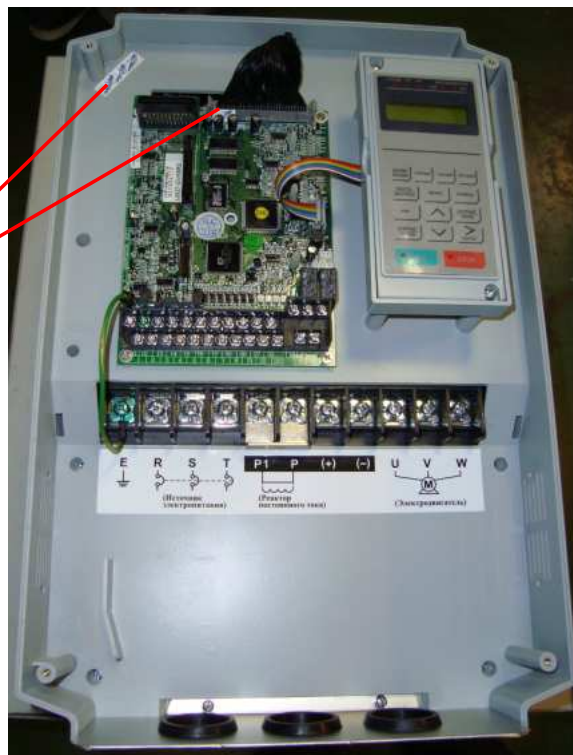
Рис. 8.3. Расположение гарантийных наклеек (ремонтных).
