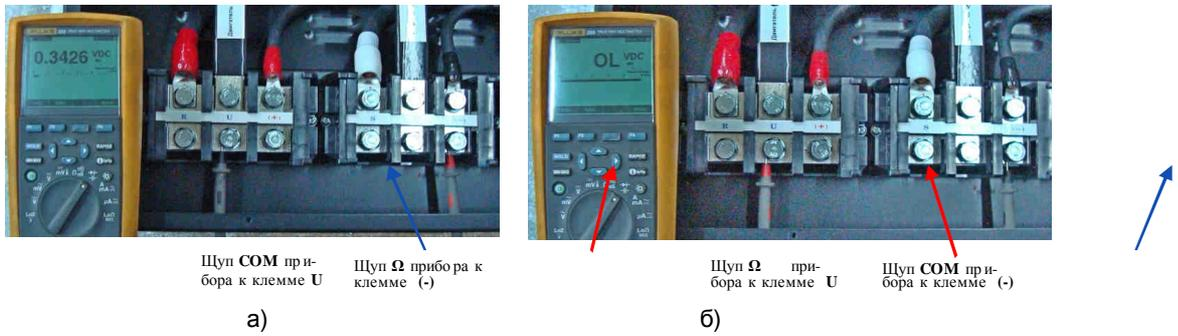
Рис. 4.17. Проверка обратных диодов IGBT-модулей относительно цепи «-».
