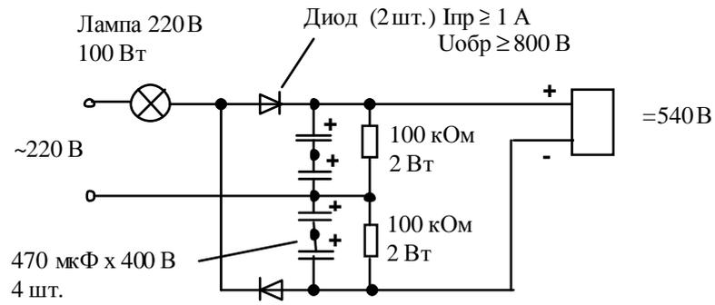
Схема электрическая принципиальная источника ≈540 В
