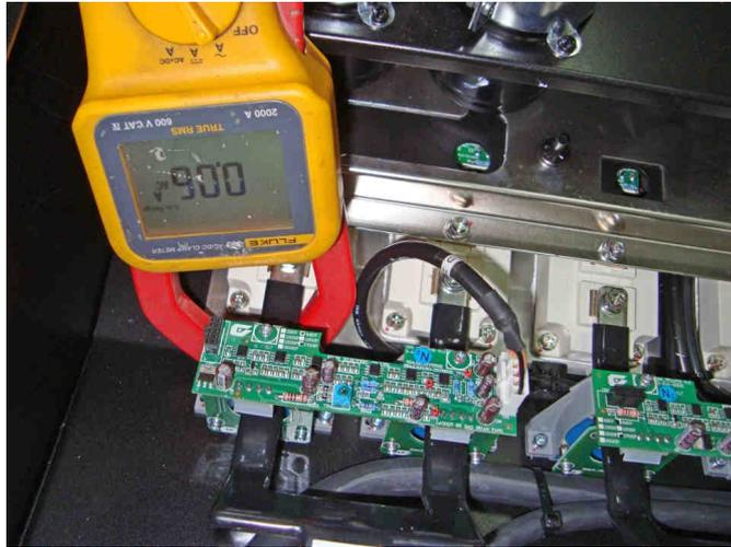
Рис. 8.3. Пример измерения тока левого модуля IGBT в выходной фазе U.
