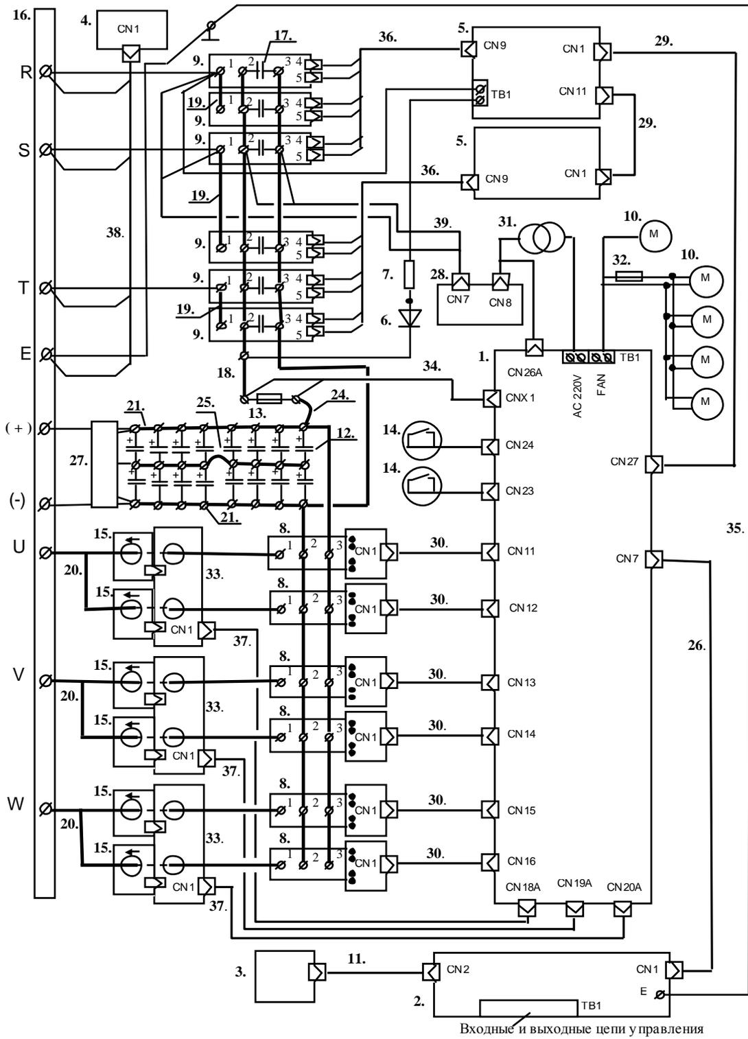
Рис. 4.2. Блок-схема преобразователя частоты EI-7011-175H, -200H.
