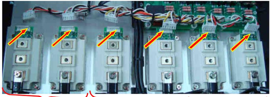
Модуль IGBT канала U                      Модуль IGBT канала V                      Модуль IGBT канала W
