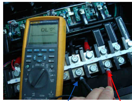
Щуп COM прибора к клемме (-)
