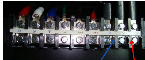
Щуп COM прибора к клемме (+) Щуп \Omega прибора к клемме U
