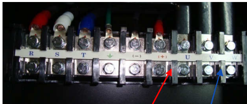
Щуп \Omega прибора к клемме (-) Щуп COM прибора к клемме U
