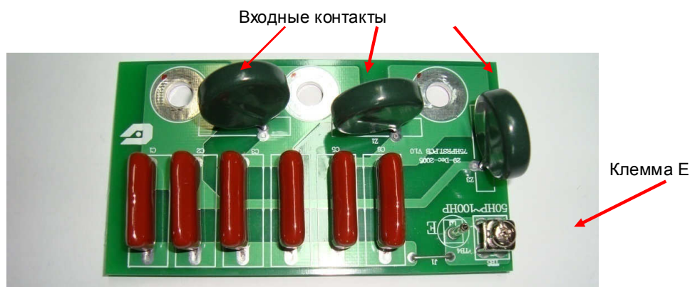
Рис. 4.15. Диагностика платы варисторов
