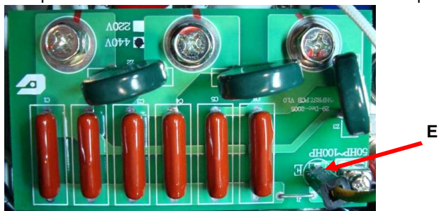
Рис. 6.6. Демонтаж платы варисторов. Е - контакт заземления.
