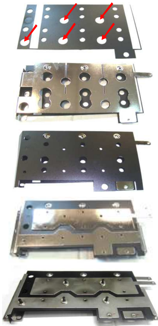
Рис. 7.12. Порядок сбора шин «+» и «-»ЗПТ.
