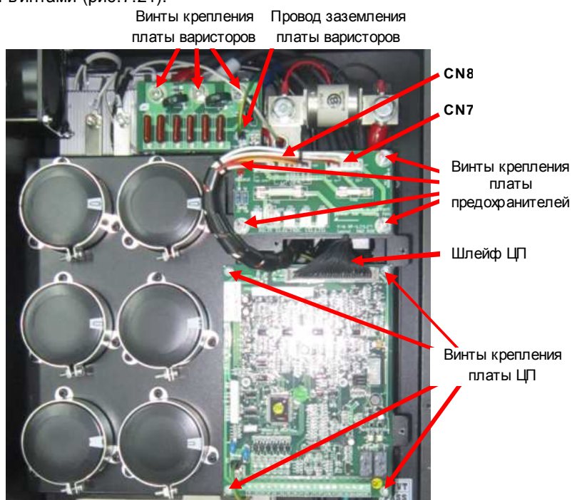
Рис. 7.21. Установка платы варисторов, платы предохранителей, платы ЦП.
