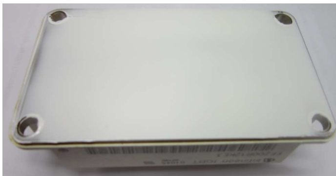
Рис. 7.6. Нанесение теплопроводного компаунда на основание силового модуля.
