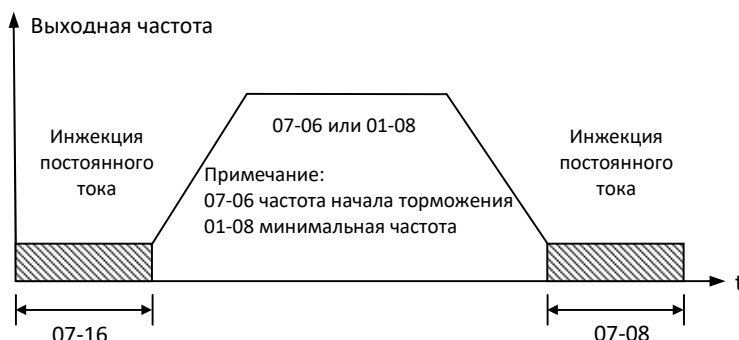
Рис. 4.3.57а Инжекция постоянного тока при торможении
