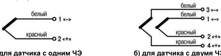
Рисунок 6.1 – Схемы внутренних соединений проводов датчиков типа ОВЕН ДТПХ ХХ4
