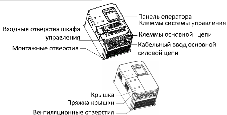
Рисунок 1.3. Наименования частей преобразователя (менее 18,5кВт)
