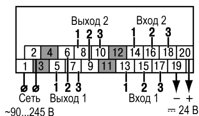
Рисунок 5.3 – Назначение контактов клеммной колодки прибора в корпусе Щ11
