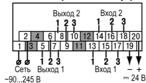
Рисунок 11 – Назначение контактов клеммной колодки прибора в корпусе Щ11
